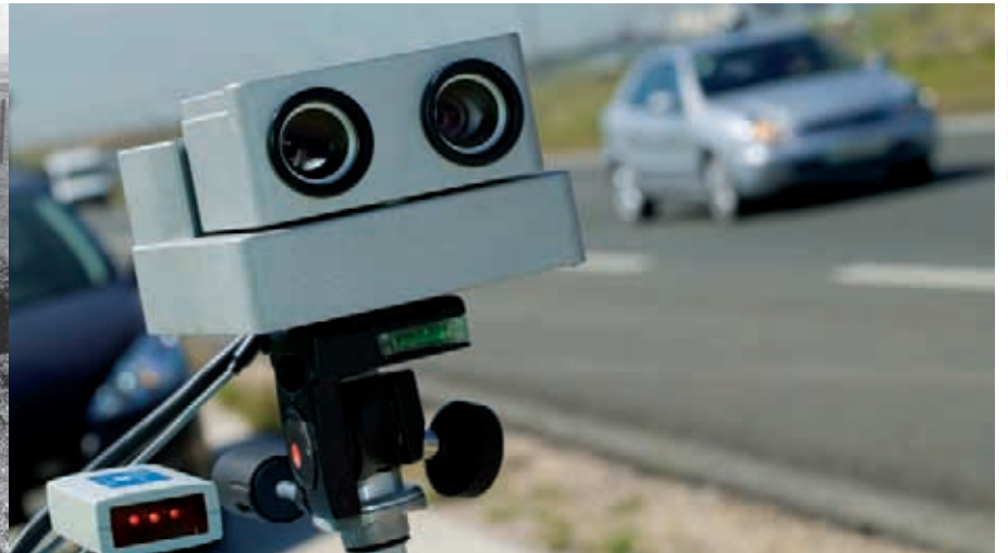
El modelo de cinemómetro "Autovelox", usado actualmente, se basa en tres rayos láser.
